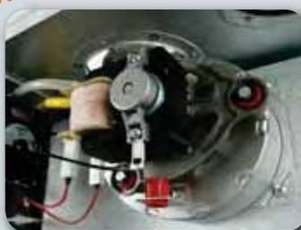
Вентилятор обеспечивает принудительный выброс продуктов сгорания и подсос воздуха для горения – поэтому котлы с закрытой камерой сгорания могут использовать специальные тонкие трубы дымохода/воздуховода вместо традиционного дымохода.
