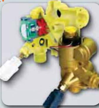
Электронный датчик расхода горячей воды (ГВС) запатентованной конструкции – вращающаяся в потоке воды турбинка – не имеет уплотнений и связана со считывающим устройством лишь магнитной связью через герметичную стенку датчика. Это исключает негерметичность и дает электронике котла очень точный сигнал о расходе воды.
