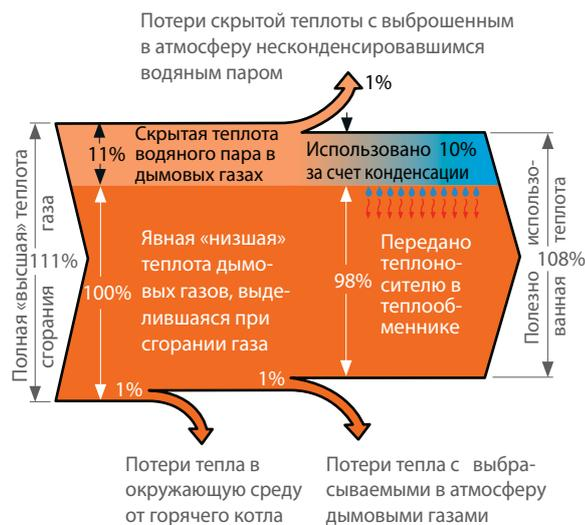
**PLATINUM:** За счет горелки предварительного смешения и эффективной конденсации водяного пара из дымовых газов высвобождается и полезно используется до 10% скрытой теплоты водяного пара (КПД до 108%)
