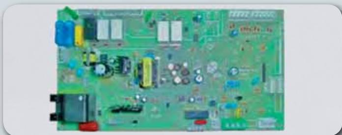
«Неубиваемая» электроника котлов ROC выполнена по удобному модульному принципу – одна и та же универсальная базовая плата подходит для нескольких моделей котлов. Нечувствительность к полярности электросети и колебаниям напряжения 160÷242 В и встроенный импульсный блок питания с современной защитой от бросков напряжения (SMPS) обеспечивают высокую надежность и долгий срок службы.
